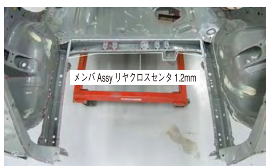
写真9 リヤ上側 リヤリヤフロア・左右リヤリヤサイドフロア取外し状態
