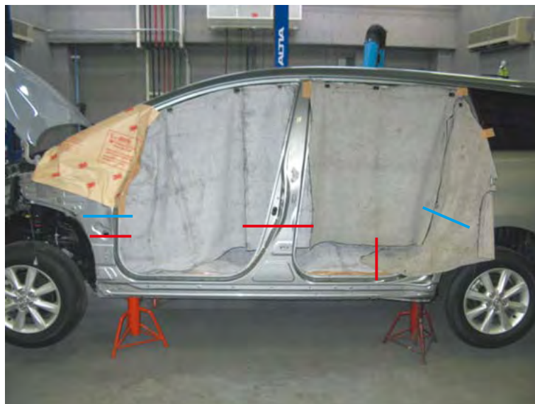
写真1 ロックパネルアウト取替作業範囲
