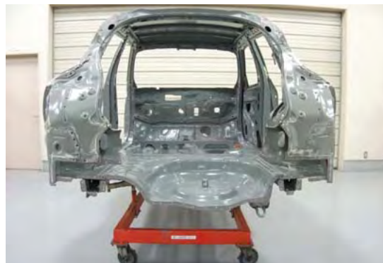
写真9 リヤ上側 リヤリヤフロア・左右リヤリヤサイドフロア取外し状態
