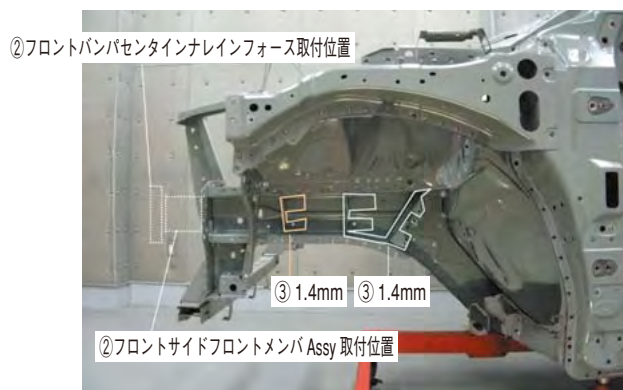
写真2 サイドフロントメンバ左外側
