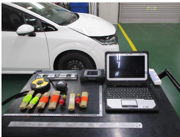
図4 基本作業指数で準備・片付けをする機器・工具の例
