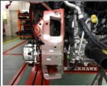
① サイドメンバ先端部の損傷状態
