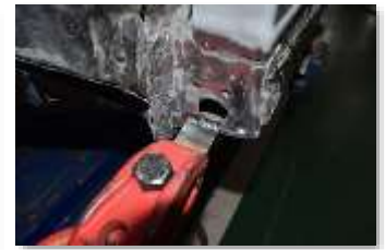
プルプレートによる引き作業
