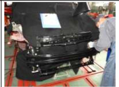
⑨ ラジエータサポート、バンパラインホースメント仮組み、合わせ
