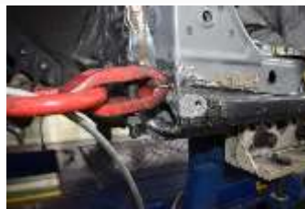
プルプレートによる引き作業
