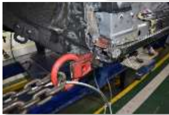
フランジ部引き作業
