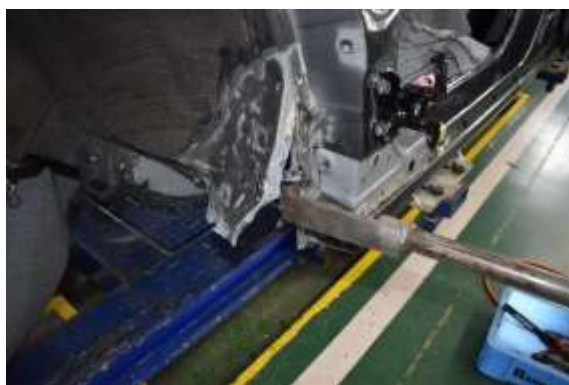
スライディングハンマによる作業
