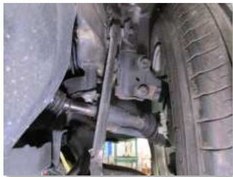
左ステアリングラックエンド 左ディスクブレーキダストカバーフロント
