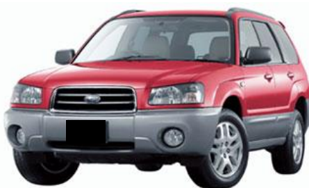
写真1 樹脂バンパの塗色が外板パネルと異なる例
