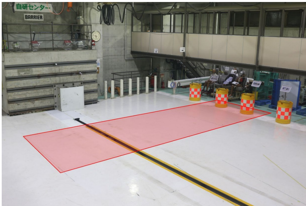
写真 1 バリア走路終端（赤色部分の地下がテンションピット）
