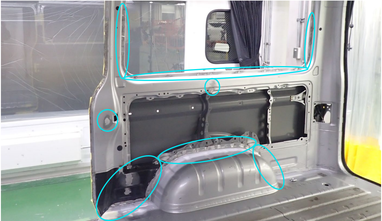
板金作業後の室内右側 (○ : パテ成形実施範囲)
