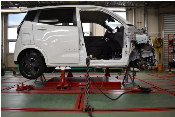
写真 18 : 引き作業 (3 回目)
