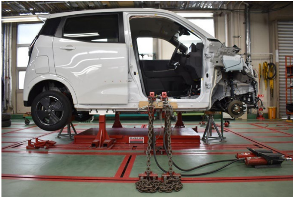
写真 16 : 引き作業 (2 回目)
