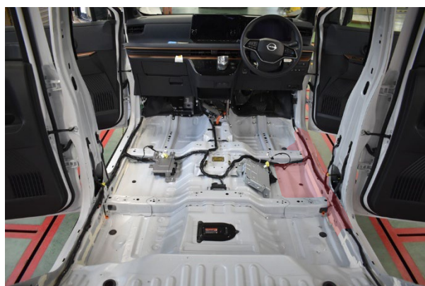
写真 4 : 室内 (赤色着色部付近が損傷)
