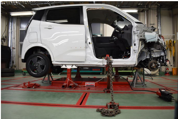
写真 14 : 引き作業 (1 回目)
