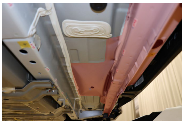
写真 3 : 右下面 (赤色着色部付近が損傷)
