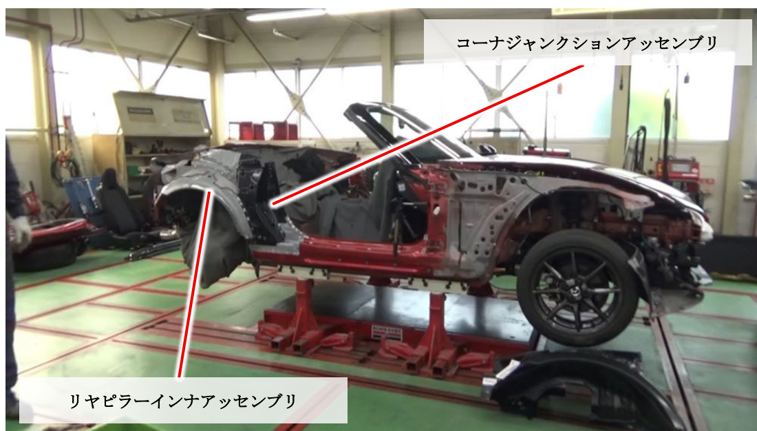
写真 7 : コーナジャンクションアッセンブリ・リヤピラーインナアッセンブリ (リヤフェンダ脱状態)
