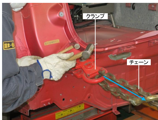
⑦ 続いて左側の凹みに、③と同様にタブ板を取付け、④と同様に反対に引いてテンションを掛けながら板金して形状を修正します。
