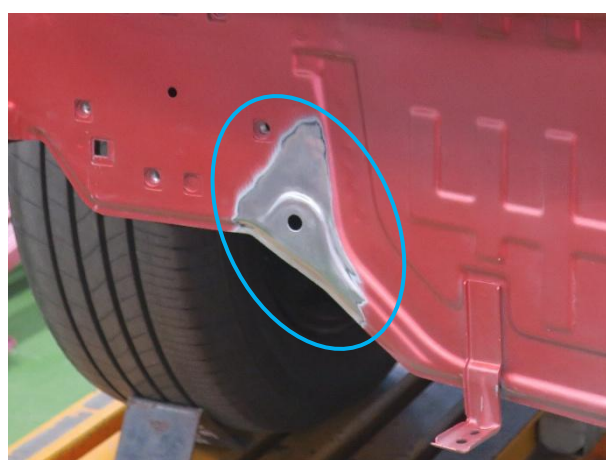
④ 形状修正直後の状態。 青丸の凹んでいた部分が修正されました。
