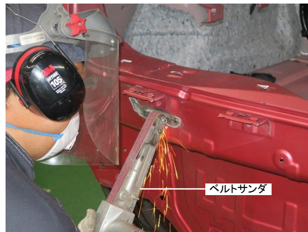
⑥ 修正後、タブ板をパネルに穴を開けないように注意してベルトサンダで削り、取外します。
