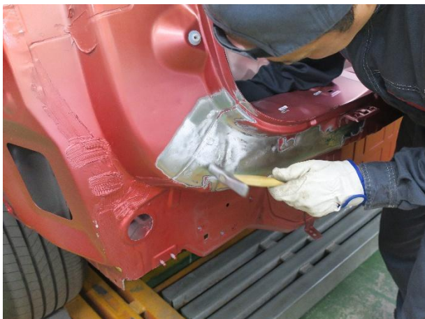
⑨ 凹み周囲の塗膜を剥がして小さな凹凸をハンマでならします。
