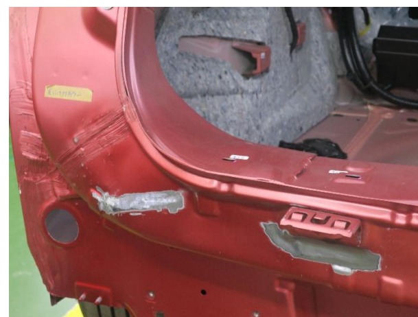
⑧ 修正後、⑥と同様の作業を行い、タブ板を取外します。
