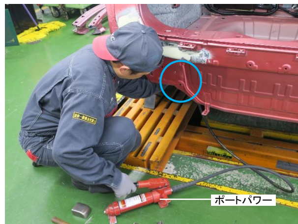
② フランジ部分を、ポートパワーで裏面から押し出します。
