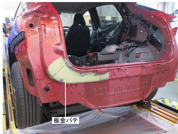
⑩ 板金パテを塗布して硬化させた後、研磨して凹み2か所の修理は完了です。
