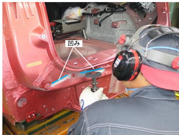
② 凹みの大きい 2 か所（青線部）の塗膜を剥がします。
