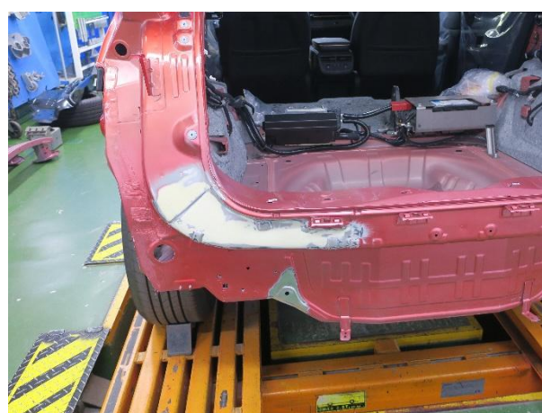
⑤ リアアッパパネルに塗布した板金パテを 研磨してリアアッパパネル、左バックアウト ピラー、リアリアフロア、左サイドリア メンバの板金修理を完了しました。
