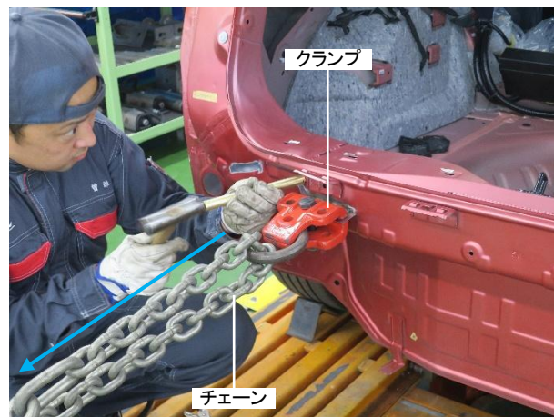
④ タブ板にクランプを取付けてチェーンをセットし、凹んでいる方向と反対に引いてテンションを掛けながら板金して形状を修正します。
