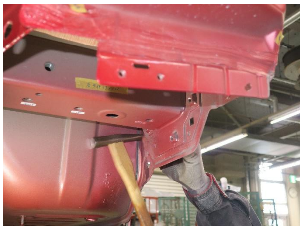
③ ポートパワーで押出した後、ハンマとドリー(当て板)で形状を修正します。
