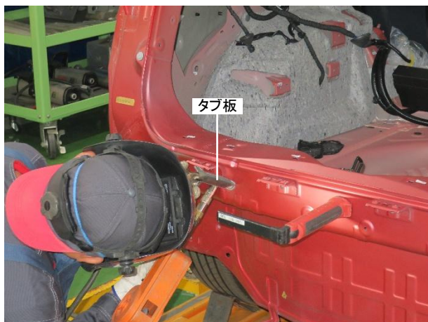
③ 凹みの形状に合わせてタブ板を切り揃え、点付け溶接します。
