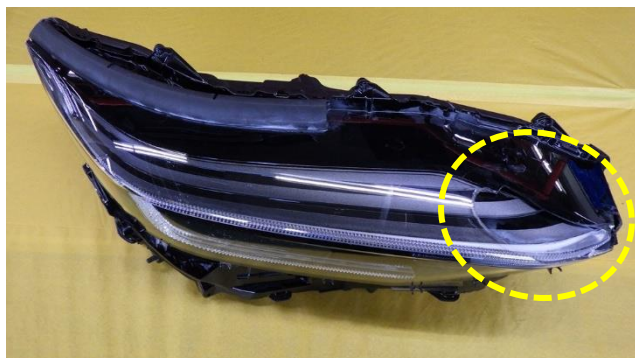
写真 1：ヘッドランプレンズ上部割れ
