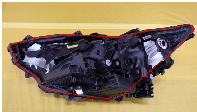
写真 3：ガスケット部加熱位置（赤点線部）
