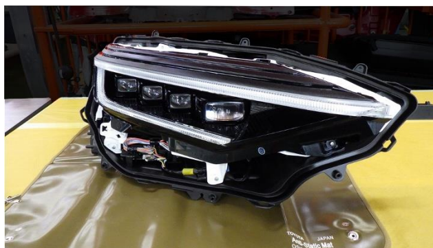
写真 7：LED イルミネーションランプ取付け
