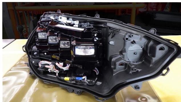
写真 6：ヘッドランプユニット取付け
