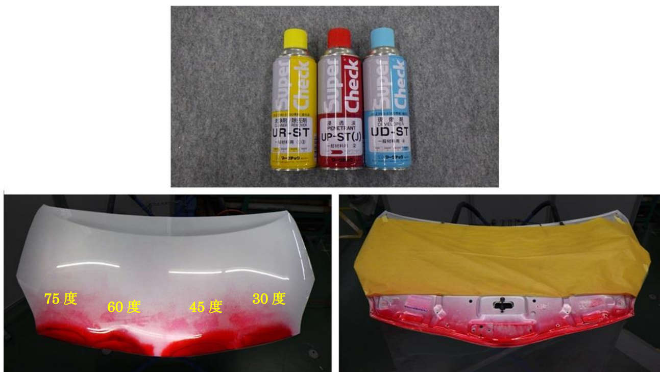
写真 14 浸透探傷試験（レッドチェック）
