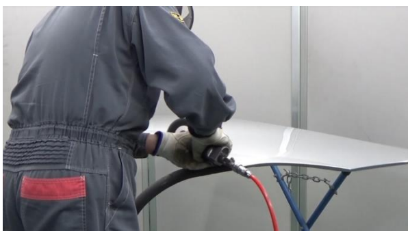
写真 3 塗膜剥離（表面）
