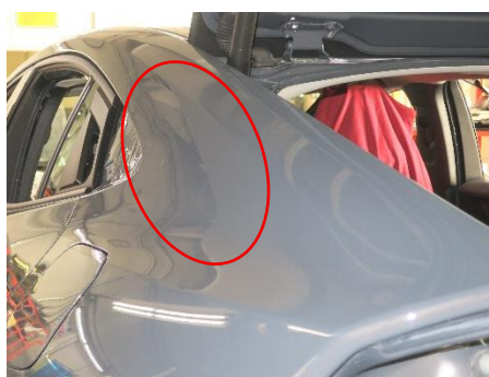
赤枠内に軽微なひずみ
