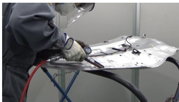
写真 4 塗膜剥離（裏面）
