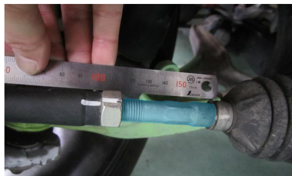
ラックエンド曲がり確認
