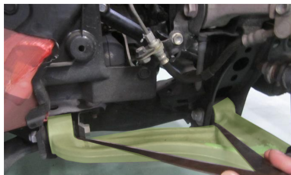
サスペンションメンバ取付部 2 点距離計測
