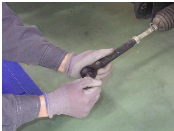
ボールジョイント：打痕なし
