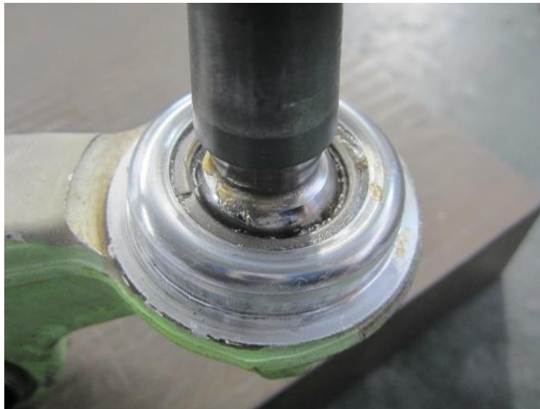
ボールジョイント：打痕なし
