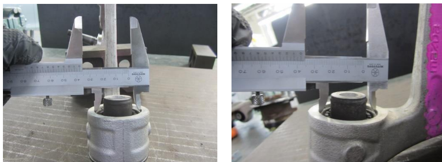
サスペンションメンバとの取付部：変形無し
