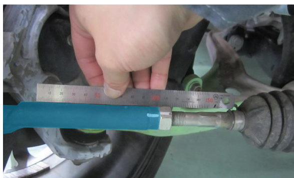
タイロッド曲がり確認
