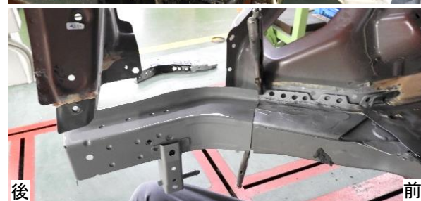
⑦ 上画像 補給部品から取替部の切出し作業 下画像 左リアサイドメンバエクステンション取替部の仮組み状態
