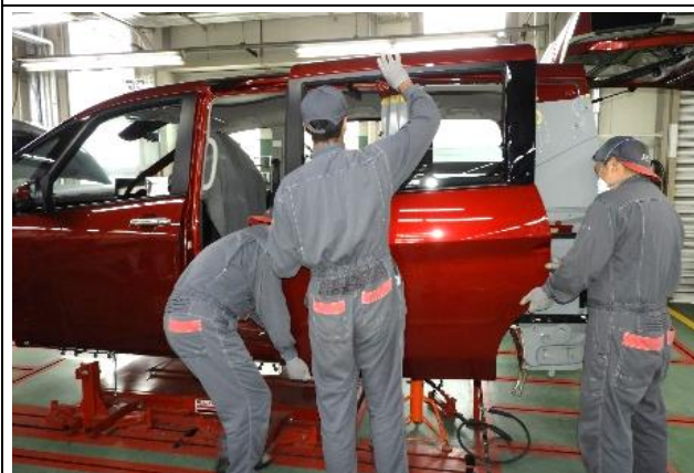
⑮ 左スライドドアの仮組み作業
