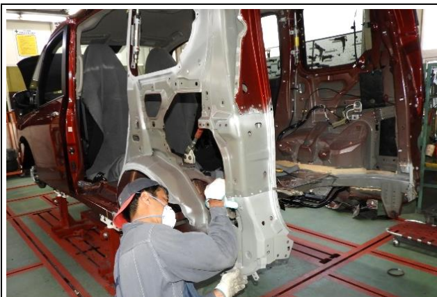
⑪ 左バックピラーロアレインフォースの仮組み作業
