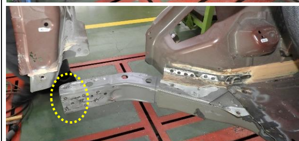
⑥ 上画像 左リアサイドメンバエクステンション取外し前の状態、テープ部が半裁位置 下画像 取替部取外し後の状態、黄丸部は形状修正部、形状修正の詳細は 39 ページ下段参照
