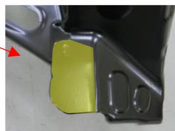
ホイールハウス部の後部は、部品を取外す際にカットした形状に合わせてカットし取り除きます。
