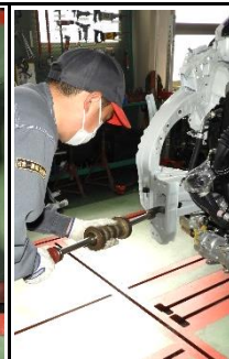
② 右フロントサイドメンバプレートクラッシュボックス座面の形状修正
