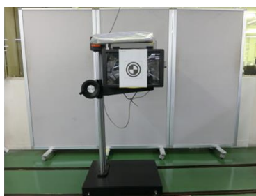
ヘッドランプテスタ設置状態
