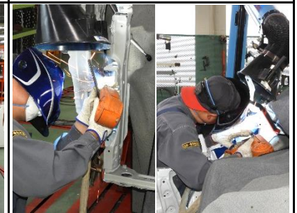
⑥ 仮組した外板や臓装品を取外し後、右ラジエータサポートの本溶接
