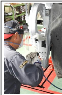
① 右ラジエータサポートの取外し 右画像は取外した損傷部品
