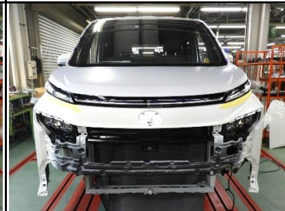
⑤ 外板・臓装品の仮組、組付け位置が正規位置になることを確認
