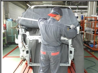
④ ラジエータサポート新品品の仮組、計測、位置決め
