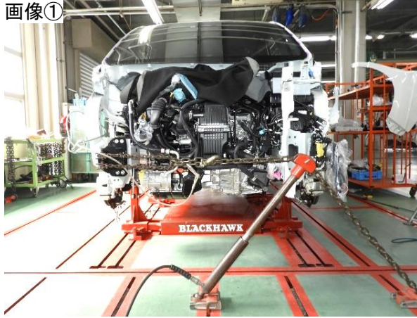
画像① 右フロントサイドメンバの外側への振れ修正作業
