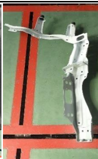
① 右ラジエータサポートの取外し 右画像は取外した損傷部品
