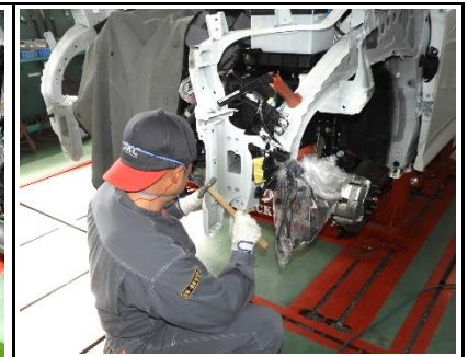
③ 左ラジエータサポートクラッシュボックス座面周辺の形状修正
