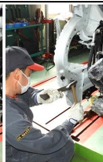
② 右フロントサイドメンバプレートクラッシュボックス座面の形状修正
