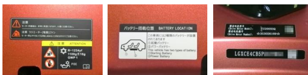
①ラジエータファン用、②バッテリー搭載位置 クーラガス用 ③モータ型式、VIN
