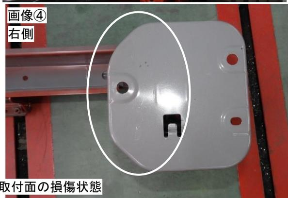
クラッシュボックス取付面の損傷状態
