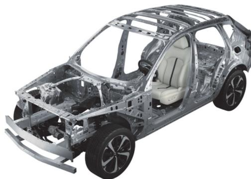
また、フロントサスペンションのタワー部はアルミダイキャスト部品を使用した構造となっており、部材の異なる周辺の鋼板部品とは溶接接合ではなく SPR<sup>※</sup>によって締結されています。そのため、損傷があった際はアルミダイキャストを含むフロントホイールエプロン周辺の損傷状況や SPR 締結部の状態を確認し、部品交換や修理の可否やその範囲を判断する必要があります。CX-60 のボディ修理書には、「アルミダイキャストの良否判断基準」が掲載されており、部品毎の修理可否や出荷形態に合わせた交換範囲について判断することができます。
