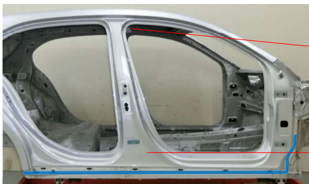
■: Bピラー、サイドシルアウト取替時、リベット接合箇所
