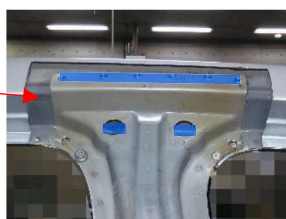
■: Bピラーリインホース取替時、リベット接合箇所
