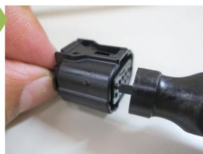
c. ランスキャンセリングツール No.2 をロック解除挿入位置に差込んで内部のツメを持ち上げてターミナル引抜きます。
