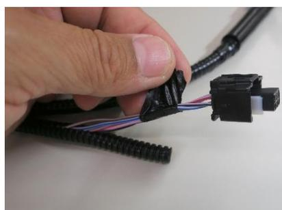
a. ターミナル脱着作業性向上のため、ワイヤを覆っている保護材、絶縁テープを外します。
