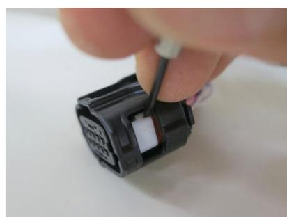
a. ターミナルを取外すため、コネクタのリテーナ解除の挿入位置に精密ドライバを掛け手前に引出します。
