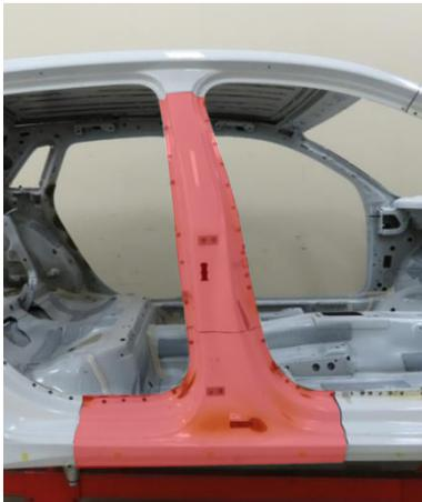
取替範囲例(D): Bピラーアウトパネル、Bピラー取替
