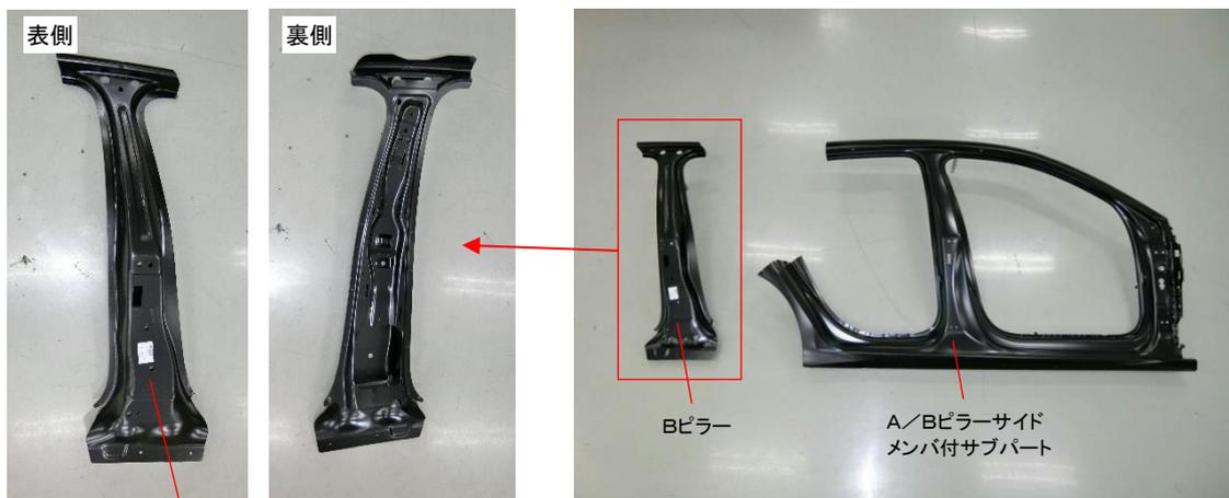
リインホース部(Bピラー表側)は超高張力鋼板が採用されています
