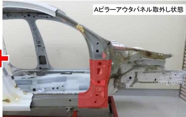
取替範囲例(D): Aピラーアウトパネル、Aピラーアウト、アウトAピラーアツパ、サイドメンバ取替 (指数なし)
