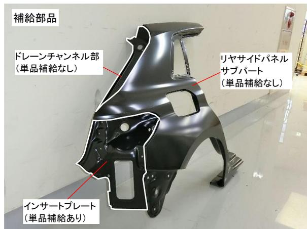
インサートプレートの一部にリヤクロスパネルが重なって取付けられています。しかし、その範囲が狭いため、リヤクロスパネルを外さずともリヤサイドパネルサブパートを取替えることが可能です。
