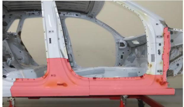
取替範囲例(C): Bピラーアウトパネル取替
