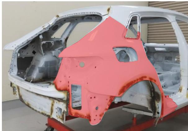
【作業範囲概要】(A)リヤサイドパネルサブパート前部のロックピラー部のみを取替
