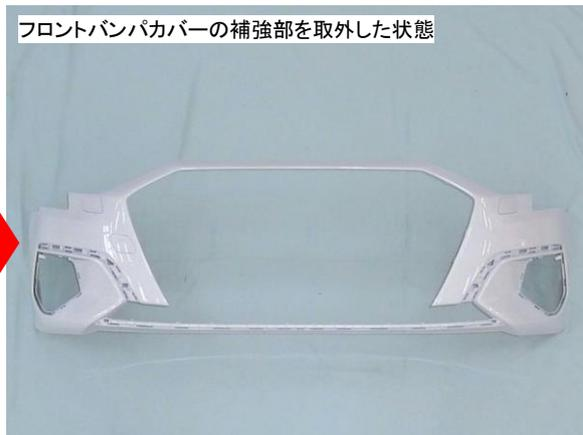
フロントバンパカバー中央部のラジエータグリルにはライセンスプレートボルトの逃げ穴、ライセンスプレートブラケット取付けスクリュー用の穴があいており、取替える際には補給部品に穴あけ作業が必要です。穴あけ位置はラジエータグリル裏側に刻印されています。
