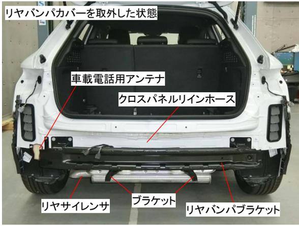
リヤバンパブラケット（バンパラインホースメント）はクロスパネルラインホース（バックパネル）にボルトで取付けられています。
