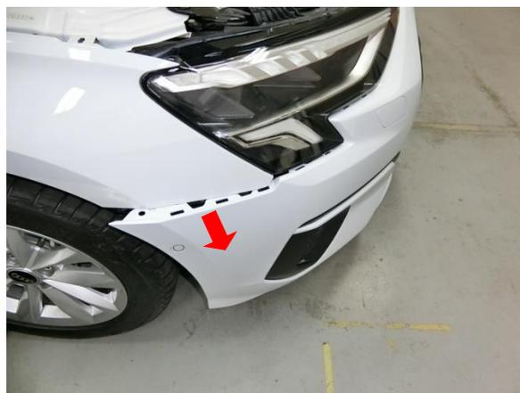
フロントバンパカバーを車両前方へ引出し左側下部でハーネスを縁切って取外します。
