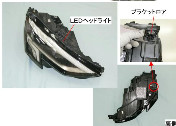
LEDヘッドライトのユニット部は単品補給が設定されていません。また、LEDヘッドライトのブラケット部が損傷した場合の補修用パーツも部品補給は2023年4月現在で設定されていません。ただし、ヘッドライトの下部のブラケットロアは、スライドさせて取外す構造で単品補給が設定されています。
