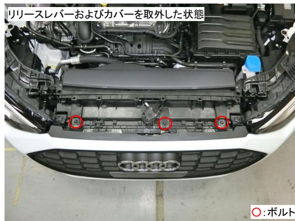
フロントバンパカバー両端部のスクリュを外し、外側へ開いてツメを外します。
