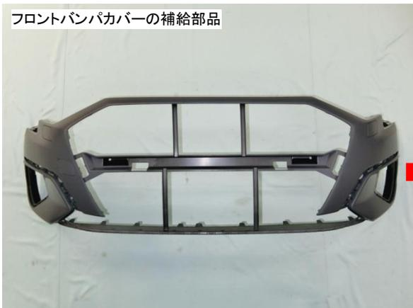
フロントバンパカバーの補強部を取外した状態
