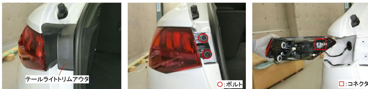
リヤバンパカバーの取付けナットを外すため、ラゲージルームフロア、リヤクロスパネル用トリムおよび両側プラグを取外します。
