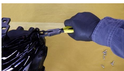
隙間確保 SST : A リムーバ使用
