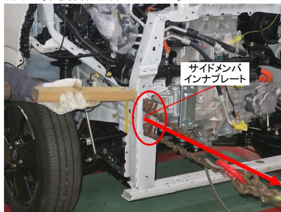
③ 引出し作業後、各部品の取付位置を確認するため、フロントバンパレインフォース、フロントバンパフェーシアや左右ヘッドランプなど外装品を取付け、関連部品と合わせ確認を行いました。
