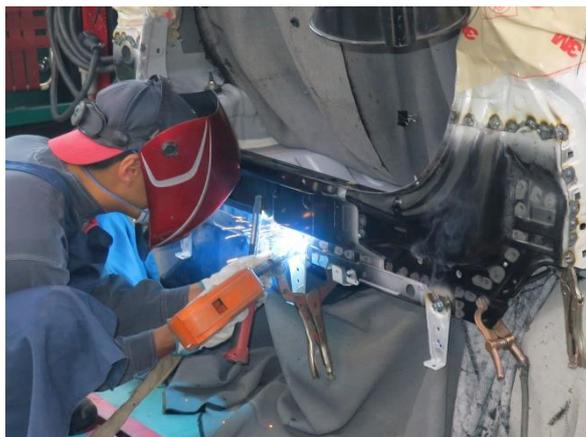
③ カットした部分を溶接し、プラグ溶接部分を研磨して作業を完了しました。
