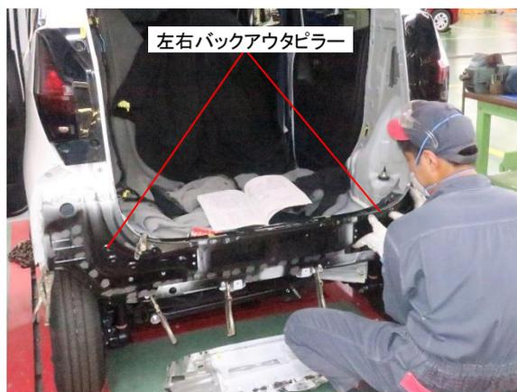
② 関連部品との合わせ確認を行った後、リアアップパネル、左右バックアウトピラーを溶接しました。
