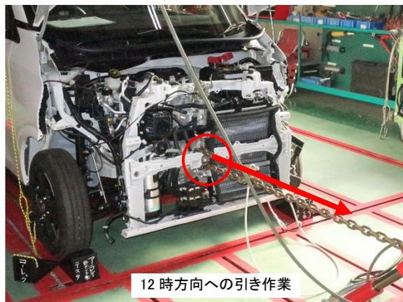
② 続いてフロントバンパレインフォースを取外し、左右サイドメンバインナプレートにクランプを取付けて左右サイドフロントメンバ前端部を12時方向へ引き作業を行いました。
