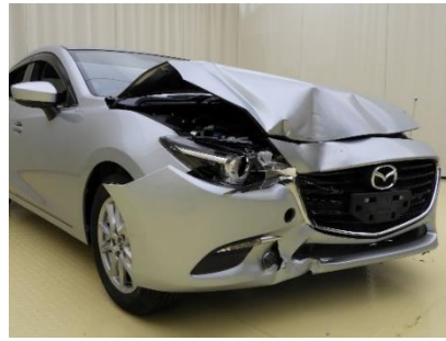
様々な条件で衝突実験を行うことで損傷を再現
