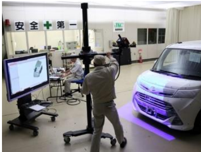
外装パネルの変位量を実験前後で計測
