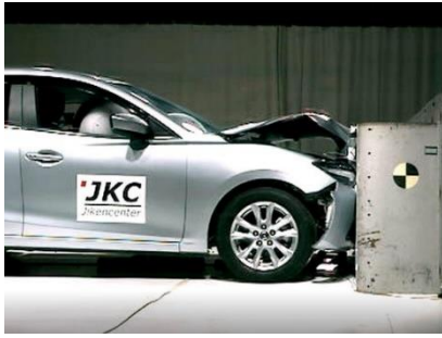
様々な条件で衝突実験を行うことで損傷を再現
