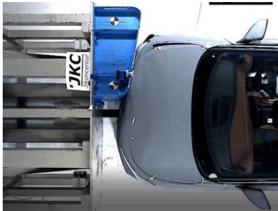
一定の条件の衝突実験で車両ごとの損傷性、修理性を調査
