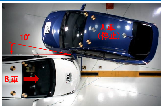
写真 2（衝突速度 25km/h 衝突角度：10°）
