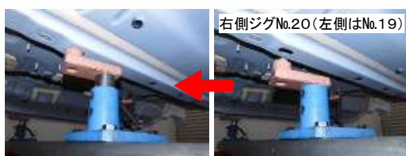
メルセデス・ベンツCクラス(W245))の基本ジグ取付状態
