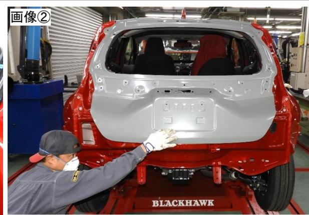
バックドア開口部の寸法復元状態確認（引き3回目の結果）
