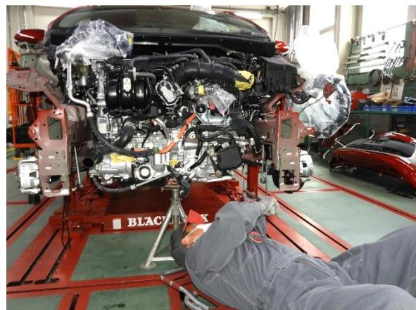
2～3回目引き作業後、前部骨格全体の復元状況の確認。
