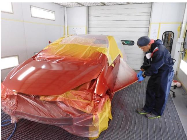
右フロントドアパネルのプラサフ部分にカラーベース塗装（色決め）および左右フロントドアパネルにぼかし塗装を行い、カラークリヤを塗装します。
