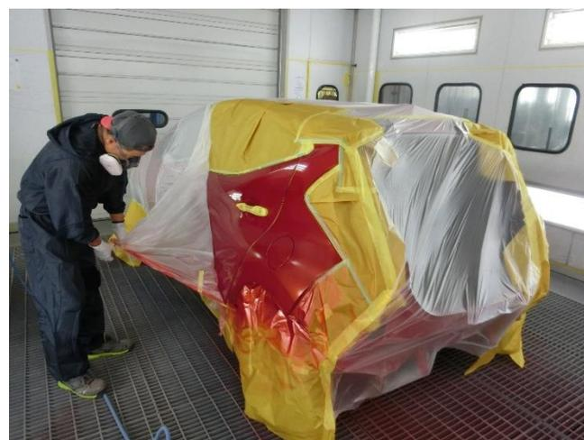
バックドア塗装および左右リヤドアパネルにぼかし塗装を行います。
