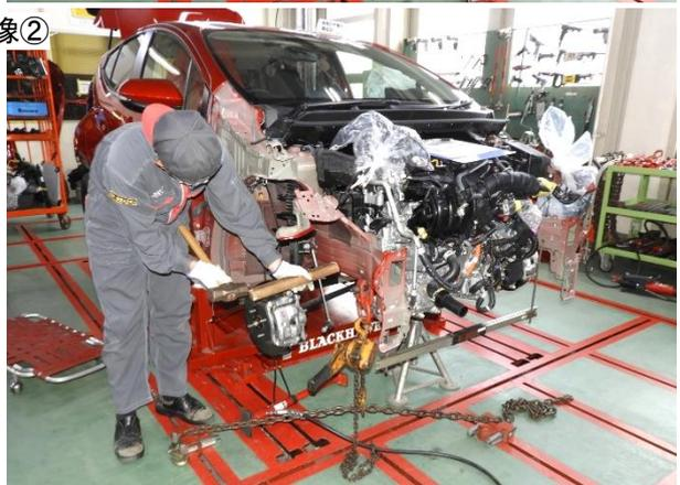
画像① 引き作業2回目、右フロントサイドメンバを下方向への引き作業、サイドメンバ前部の範囲を修正するため、サイドメンバ中央後部へポートパワーによる下支えを行う。
