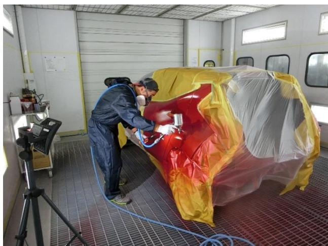
強制乾燥後、マスキング剥がし、ブツ（ゴミ）などをペーパー研磨、コンパウンドなどで仕上げ、艀装品を取付けて完成です。
