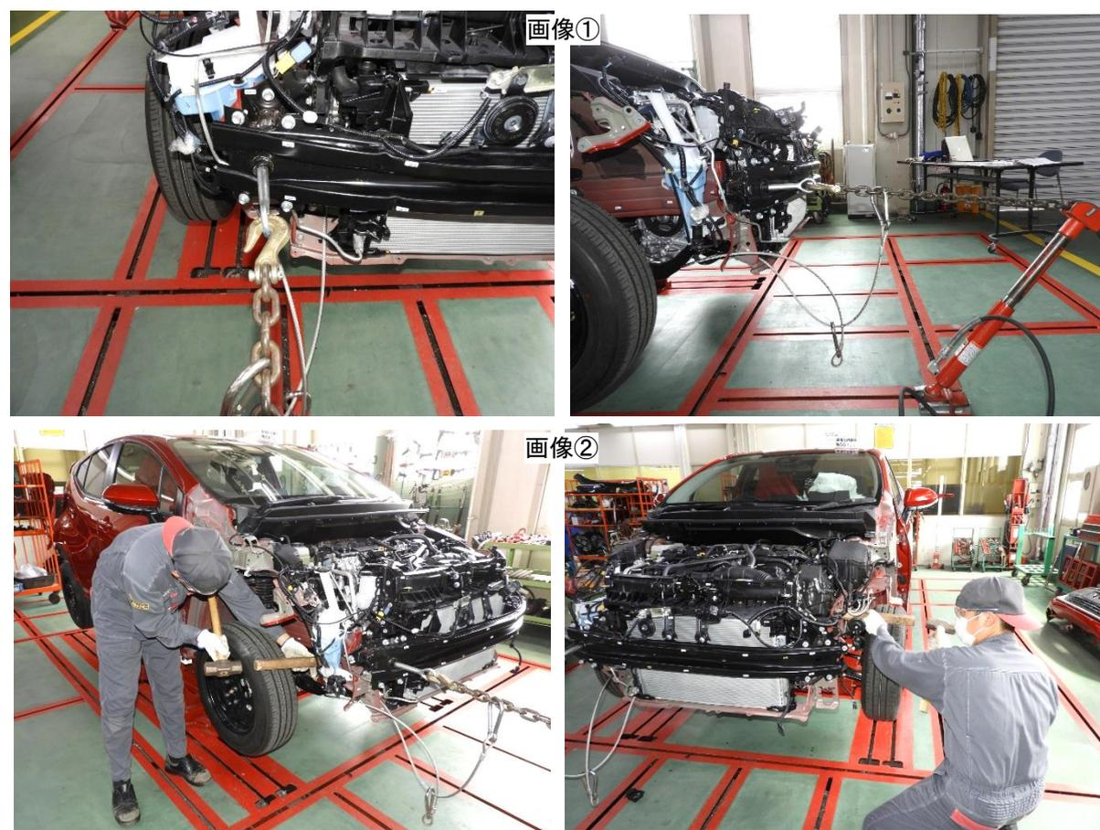
フロントバンパラインホースメント右側（右フロントサイドメンバ側）を強く引き、バンパラインホースメントを元の形状に近づけることで、右側骨格の引出しと持上り、左側骨格の振れの修正作業を行う。
