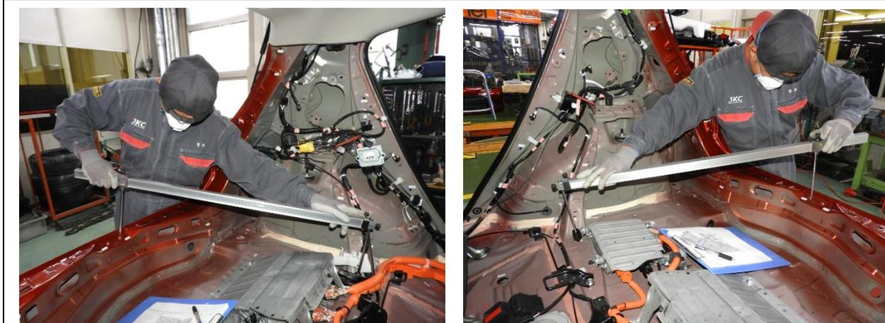
アンダボデーの寸法復元状態確認（引き1～2回目の結果）
