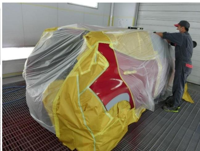
左右クォータパネルのプラサフ部分にカラーベースを塗装（色決め）し、リヤドアパネルのマスキングを剥がします。
