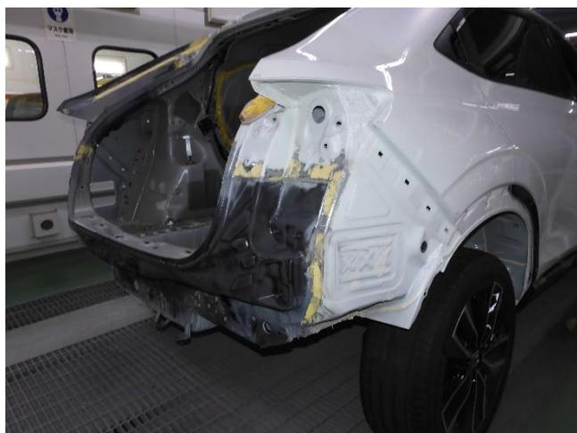
マスキング後、脱脂、清掃し、2液型プラサフを塗装します。
