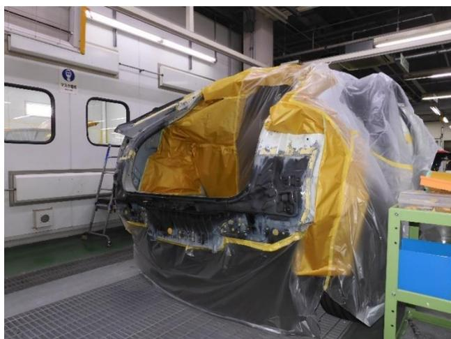
プラサフ塗装・乾燥後、パテの巣穴や小キズなどあれば拾いパテ（ラッカーパテ）で充填します。プラサフ、拾いパテともに研磨後、左リアアウトサイドパネル、リヤパネルの隙間などに左右対称になるようボデーシーラを塗布します。
