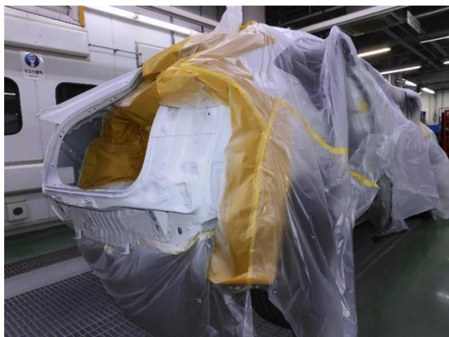
隣接するパネル（左リヤドア、右リヤアウトサイドパネルなど）にぼかし塗装を行うためコンパウンドなどで足付けを行います。上塗り用マスキングを行い塗装します。
