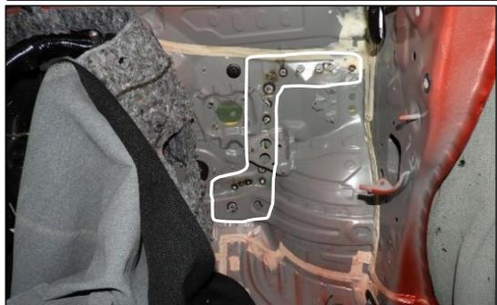
フロントダンパハウジング、フロントサイドフレームの溶接の範囲（白枠部）と状態
