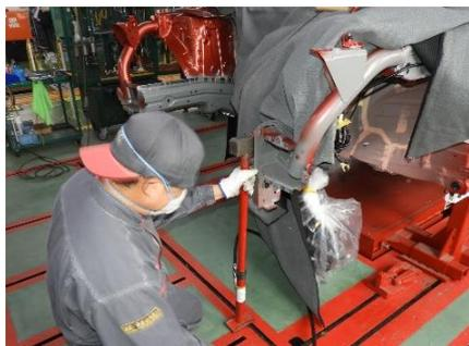
⑤ ポートパワーで下支えをしながらサイドフレーム先端部の形状修正
