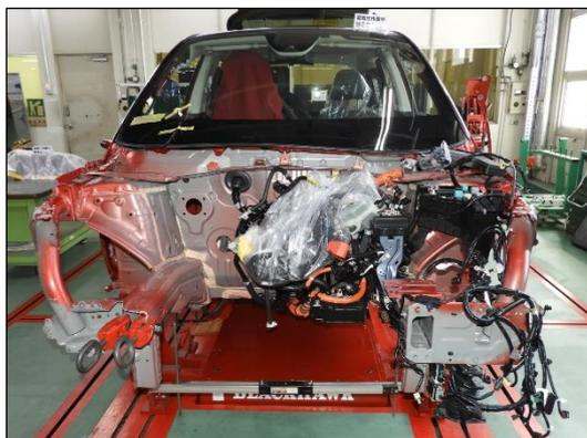
Fr ルーム側の取外し状態、ダッシュインシュレータの装着がないため左側の補機類や高電圧ケーブルなどを残した作業が可能
