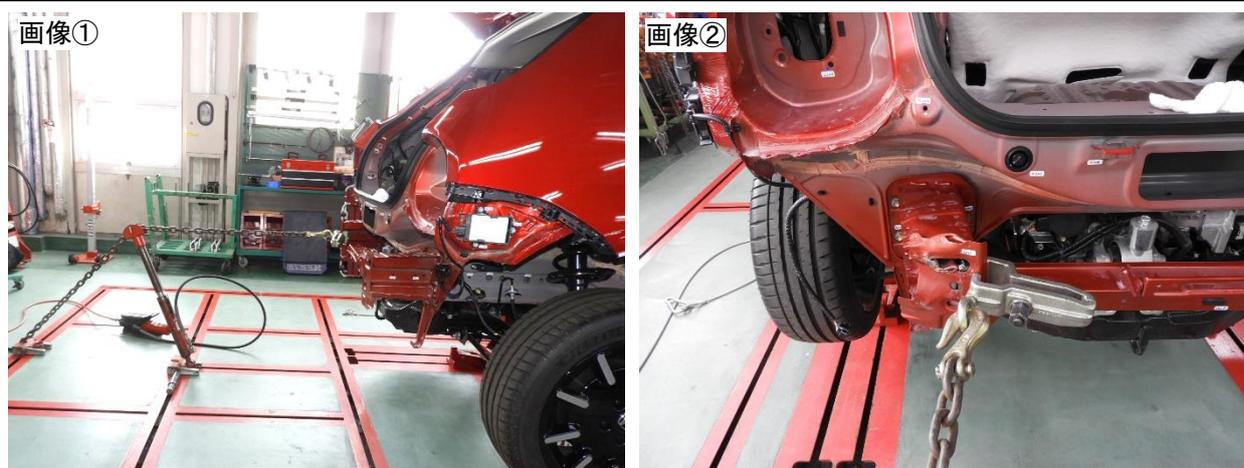
左リヤフレーム後端リヤバンパビーム取付面およびリヤフロアパネル左後端部の粗修正
