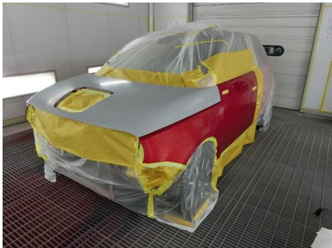
カラーベースやカラークリヤでフロントドアにミストを飛ばさないようにドア側にマスキングを施します。
