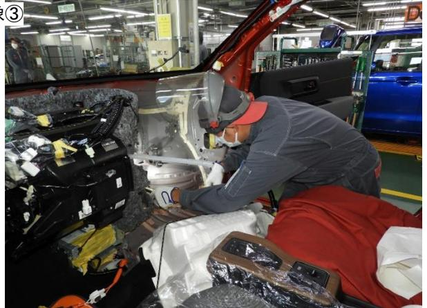
右フロントサイドフレームおよび右フロントダンパハウジング取外し前の修正、ロアダッシュボード右側接合面の引出し修正
