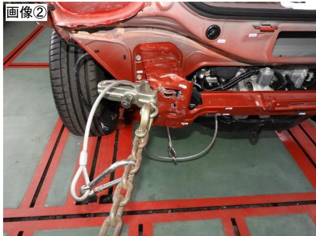
左リヤフレーム後端リヤバンパビーム取付面およびリヤフロアパネル左後端部の粗修正
