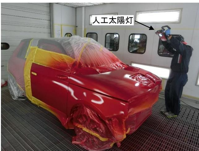
強制乾燥後、マスキングをはがしブツ（ゴミ）などをペーパー研磨、コンパウンドなどで仕上げ艱装品を取付け、完成です。
