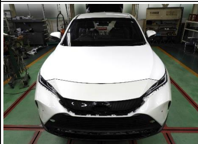
⑧ 仮組み・合わせ完了。この後、艤装分解のうえラジエータサポートを溶接
