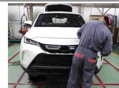
⑦ 外板パネルの隙間・段差確認調整
