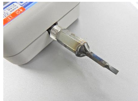
各道具と M6 メネジを溶接し、フォースゲージに装着。
