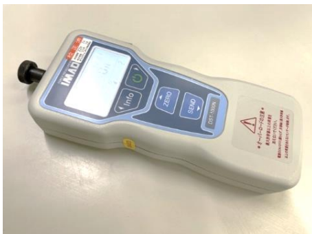
イマダ社製フォースゲージ DST-1000N。最大 1,000N までの押し引き方向の力を測定することが可能。
