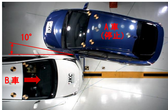
写真 2（衝突速度 25km/h 衝突角度：10°）
