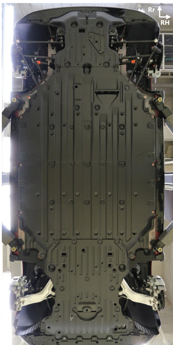
アンダカバー類取付状態
