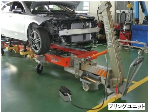
※右側アブソーバが潰れていたため、プリングユニットを使用して、クロスメンバを12時方向に軽く引きフロントメカ部品を取外し易くする作業を行いました。
