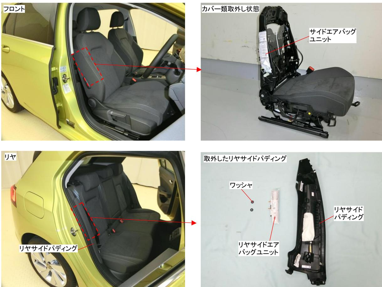
サイドエアバッグユニットを取外すには、シート高さ調整ハンドル、シートフレームトリム、バックレスト調整用ロータリノブ、バックレストロア部調整用ハンドル、カバーキャップインナ、ヘッドレストおよびカラーを取外したのち、バックレストカバーおよびバックレストパディングを一体で取外します。
