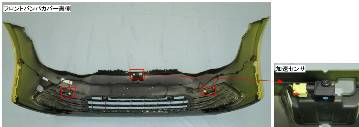
ロックキャリア中央部に1個取付けられており、ラジエータグリルを取外すと確認できます。
