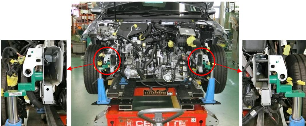
クロスメンバ（フロントバンパラインホースメント）を取外した後は、左右のサイドメンバ共にセレットの専用ジグがぴったり合ったため、今回は寸法を復元するための引き作業は行っていません。
