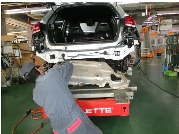
リヤセンタピース（バックパネル）の板金修正作業を行うために、ヒートシールドを取外します。
