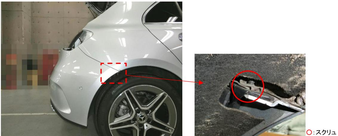
リヤバンパトリムを取外す際、サイドウォールテールランプの下部のツメを外すためサイドウォールテールランプを取外します。リヤバンパトリム両端を外側に開きながら取外し、電気ケーブルハーネスをボデー側のバンパ用ベースキャリアセンタから外して取外します。取付ける際は、電気ケーブルハーネスをバンパ用ベースキャリアセンタにはめ込む必要があります。
