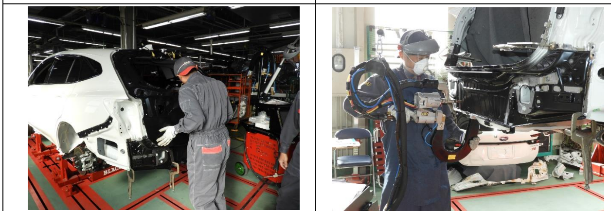
③ 現物（リヤゲート）を使用しての組付け位置確認
