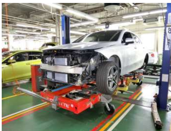
二柱リフトを使用してセベンベンチに車両を搭載した状態 (メルセデス・ベンツ Aクラス(W177))
