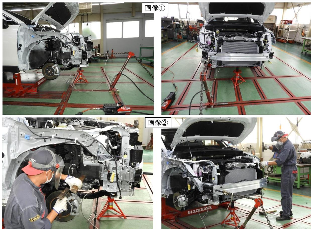
画像① フロントバンパラインホースメントを取付けた状態で、右フロントサイドメンバを引出すことで左側骨格の外側への押出し（振れ）戻す効果も期待できる。
