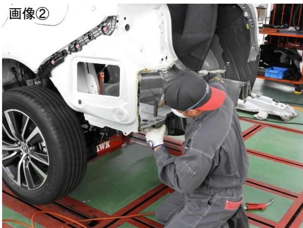
画像① ボデーロアバックパネルからの押込みをポールとチェーンブロックを使用して引出しながら修正を行う。
