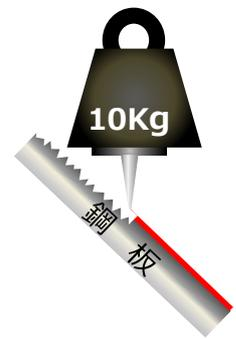
また損傷が鋼板に達したものは、損傷が直線状にならずギザギザ状の傷が生成され、それ以上の力を加えることができませんでした。これは、道具が鋼板に到達したことで引っ掛かりが発生したためですが、鋼板到達時の引っ掛かりは、塗膜により発生する引っ掛かりに比べ突破するのが極端に難しく、結果として引っ掛かりと反発が繰り返されることにより生成されます。
