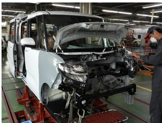
ボルトで取付けられる外板パネル、ボルト系部品を仮付けしてパネルの合わせ作業を行います。
