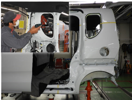
クォータウインドウガラスを取外し、ボデー修理書よりクォータパネルの切継ぎ位置を指定。
