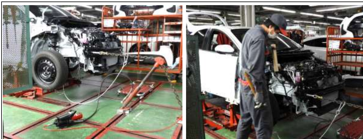
③ 寸法復元作業（1回目） ボデー構成部材の中で最も引張り強さの高い(1,780Mpa)、バンパラインホースメントの右側（右 Fr サイドメンバ側）に大きな力をかけながら、バンパラインホースメントの形状を復元することで、右 Fr サイドメンバを中心に左クラッシュ BOX 側の復元も同時に行う。
