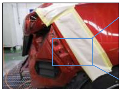
① プラサフ塗装面に水分が残った状態
