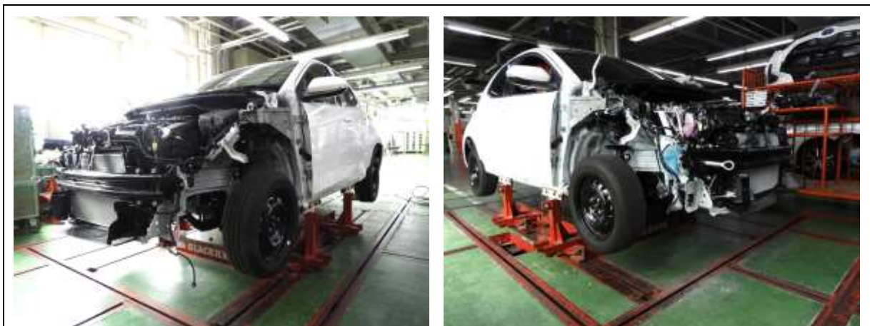
① 損傷車両のマウント状態 コーレックウイニングアンカによる4点固定の状態
