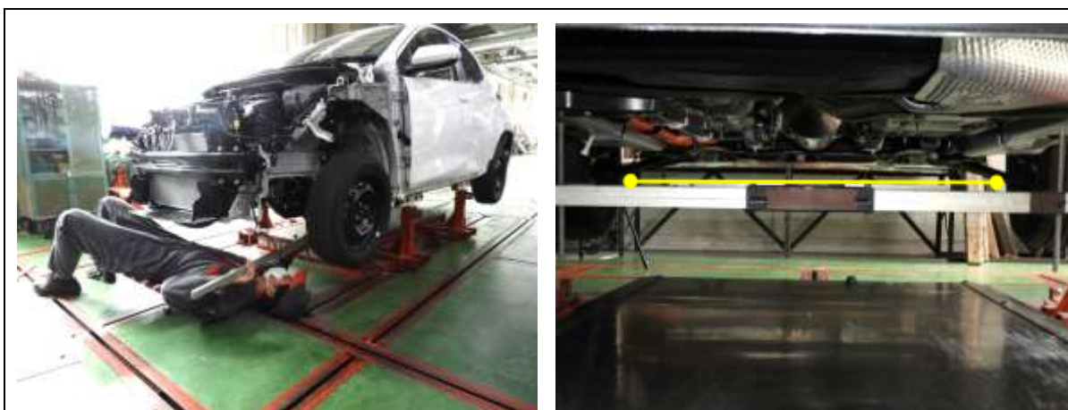
② 事前計測作業 エンジンやサスペンションが取付いた状態での計測のため、測定可能な計測点および無損傷部位との対比による計測で精度を高めている。 右画像:センタリングゲージは車両後方からの撮影、前側ゲージが右上がりになっている。
