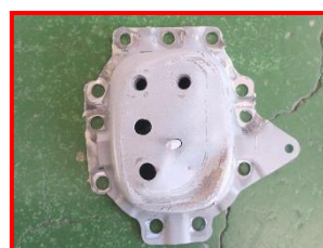
取外した左右リヤバンパラインホースメントプレート(e)。
