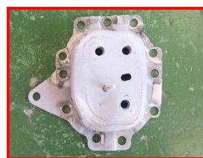
取外した左右リヤバンパラインホースメントプレート(e)。
