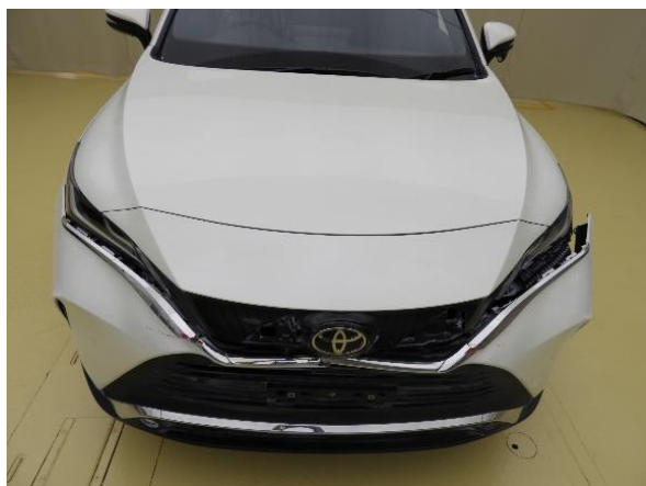
外板パネル損傷
