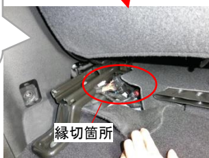
ハーネス縁切 右側フロントシート下部でフロアカーペットをめくりハーネスを縁切る。
