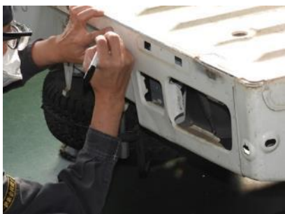
スポット溶接点をマーキング
