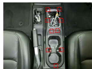
ギアシフトインディケーターベゼル クリップで取付けられている。 ハーネスを縁切る。
