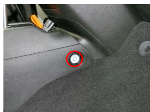
両側コンソールプラグを取外し、ボルトを外す。
