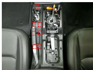
フロアコンソールベゼル クリップで取付けられている。
