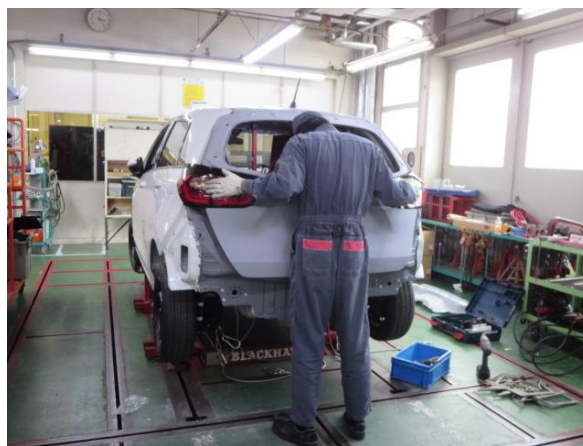
左右テールライト Assy を取付けて、各部品の建付けを確認しました。
