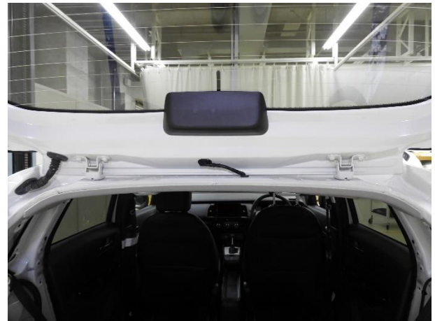
テールゲート COMP ヒンジ部を撮影しました。ヒンジ取り付け相手部位へ顕著な変形は見られませんが、ルーフパネル COMP の波及損傷(歪み)を考えると分解後、リヤルーフレールの確認が必要です。
