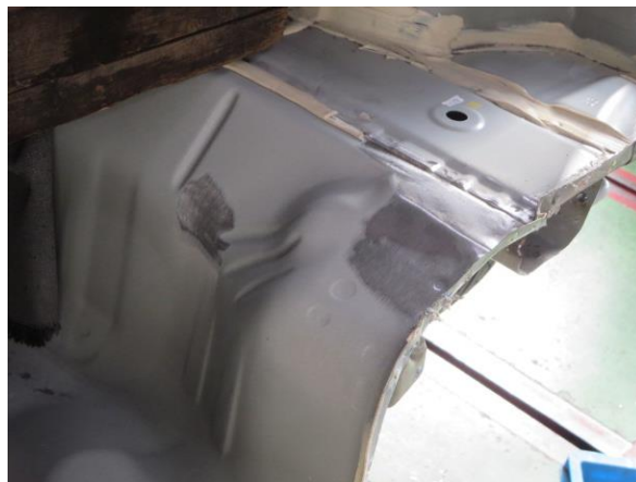
リヤフロア部修正後の状態
