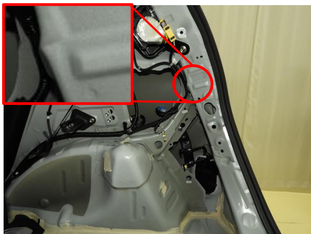
環状閉断面構造にあたる左右リヤーインサイドアップパネル部には押込みにより損傷していました。
