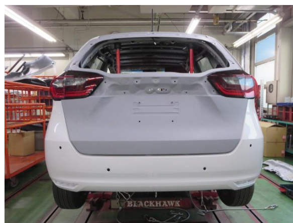
リヤーバンパフェイスを取付けました。
