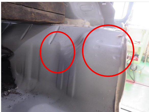
リヤフロア部の損傷状態
