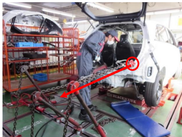
引き作業 3 回目
