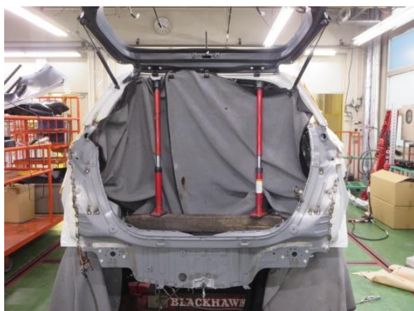
リヤーパネル COMP を溶接して取付けました。
