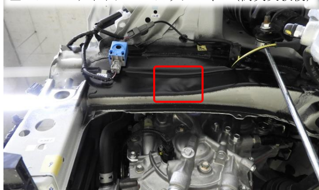
左エプロンサイドメンバアウトパネル（衝突実験後）
