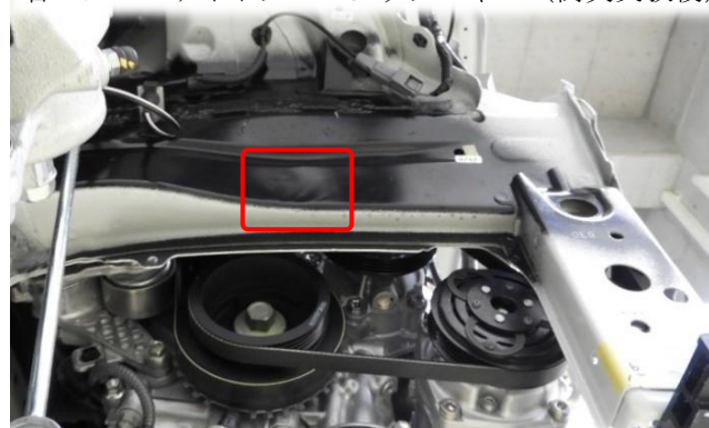
右エプロンサイドメンバアウトパネル（衝突実験後）
