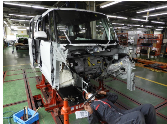
新品部品の取付寸法を計測し、ボデー寸法図と照合しながら位置を合わせて行きます。
