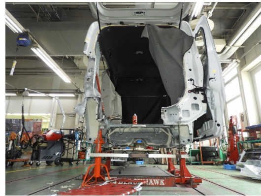
損傷部品を取外した状態。
