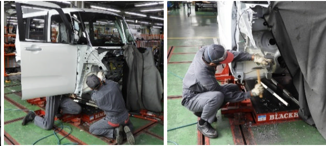
フロントフェンダエプロンサブ Assy、ダッシュパネルサブ Assy の形状修正作業を行います。
