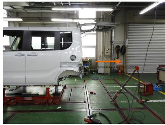
クランプをクォータパネルにセットし 6 時方向、水平に引出し作業 3 回目。
