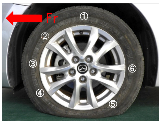
縁石の側面に接触後
