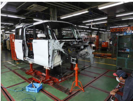
センタリングゲージによる高さ・水平位置の確認・調整作業。
