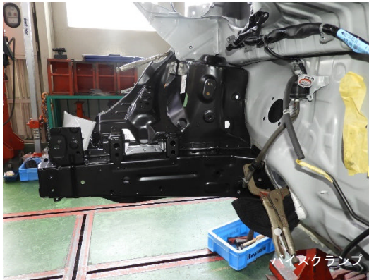
新品部品のフロントフェンダエプロンサブ Assy をボデーに仮止めします。
