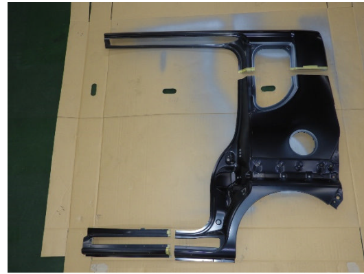
クォータパネル補給部品の下処理。
