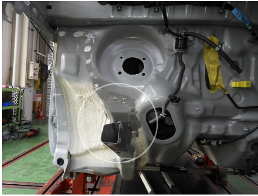
フロントフェンダエプロンサブ Assy、ダッシュパネルサブ Assy の形状修正作業を行います。
