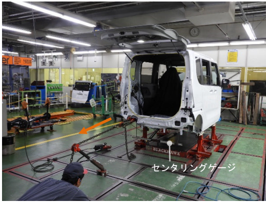
高さを確認し、リヤサイドメンバサブ Assy を 6 時方向、下向きに引出し作業 2 回目。
