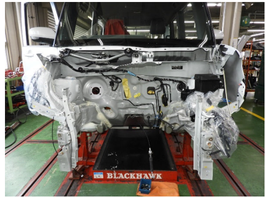
エンジンルーム内の配線・配管および付属品を 取外します。
