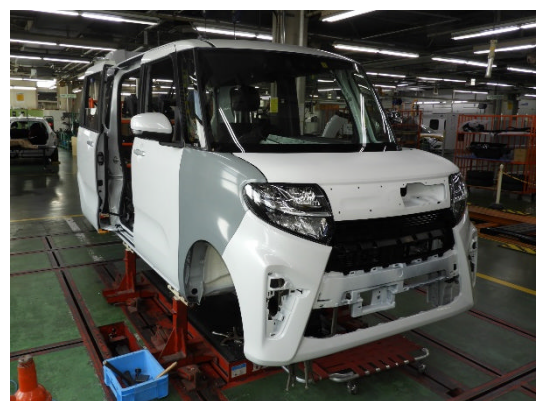
ボルトで取付けられる外板パネル、ボルト系部品を仮付けしてパネルの合わせ作業を行います。
