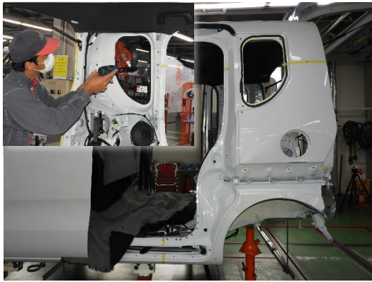
クォータウインドウガラスを取外し、ボデー修理書よりクォータパネルの切継ぎ位置を指定。
