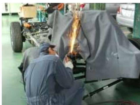
シャシフレームに残っている溶接ビードを削り落として、フロントレールエクステンションの残りを取除きます。
