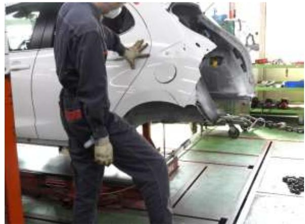
左リヤドアとクォータパネルの隙間・段差が規定位置内を確認し作業終了
