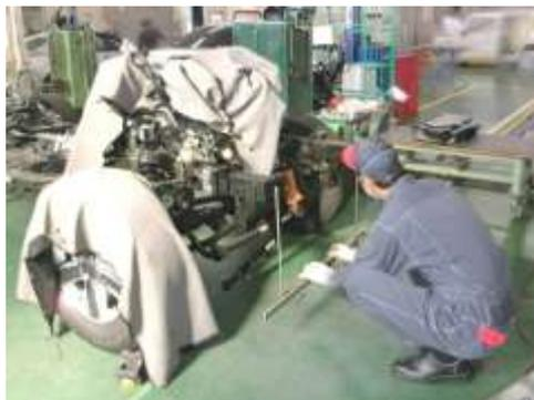
補給部品を取付け、寸法計測を行い取付位置を調整します。
