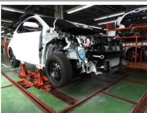
① 損傷車両のマウント状態
