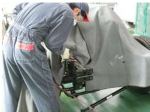
周囲を養生した後、シャシフレームとフロントレールエクステンションの接合部付近を粗切りしてフロントレールエクステンションを取外します。
