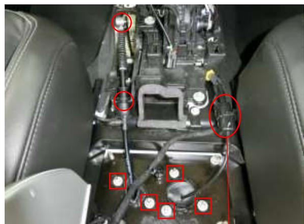
トランスファケーブルを縁切するため、パーキングブレーキレバーAssyの取付ナットを外し、脇に避けておく。
