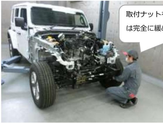
取付ナットを取外す。取付ボルトは完全に緩めておく。
