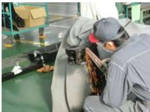
シャシフレームに残っているリヤフレームクロスメンバを接ビードと共に削り落します。
