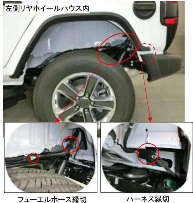
(5) 室内トランスミッションケーブルおよびトランスファケーブル縁切作業
