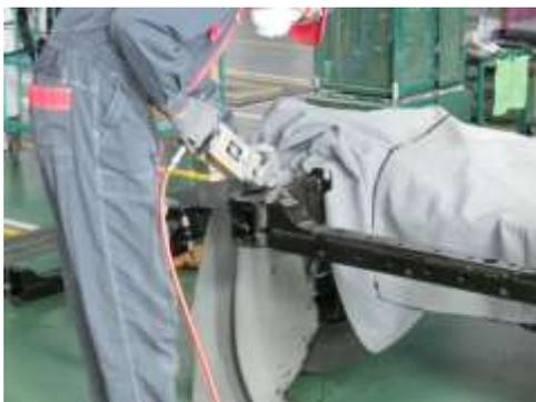
シャシフレームとリヤフレームクロスメンバの接合部付近(左右)を粗切りしてリヤフレームクロスメンバを取外します。
