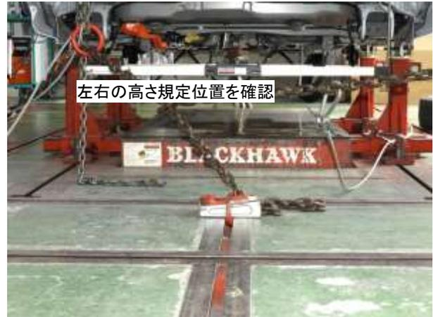
リヤフロアの取外し、リヤサイドメンバ半裁後の修正にて、規定位置への修正を確認し作業完了
