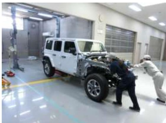
車両後方をガレージジャッキで支えながら、リフトに搬入する。
