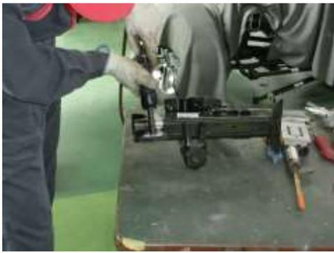
補給部品の塗膜を剥離して溶接作業に備えます。
