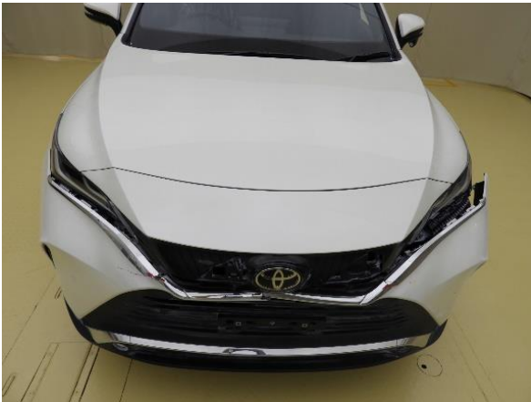
外板パネル損傷
