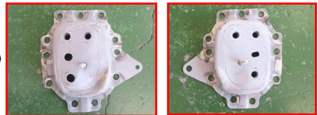
取外した左右リヤバンパラインホースメントプレート(e)。
