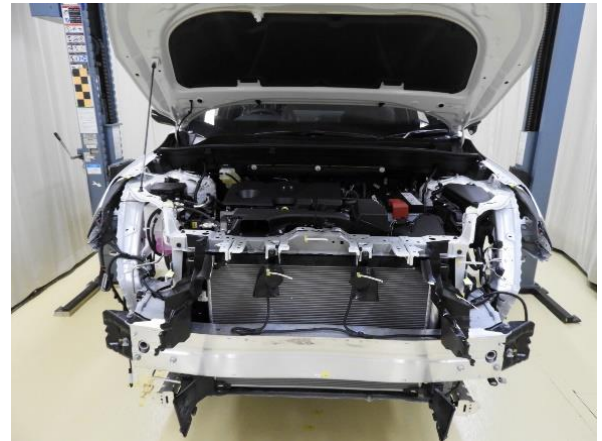
内板骨格損傷
