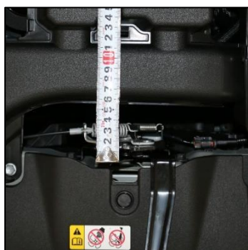
②ラジエータサポートサブ Assy アップ (e)、フードロック Assy とエアクリーニンレット
