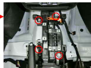
トランスミッションシフトプレート ボルトで取付けられている。 ケーブルおよびハーネスを縁 切る。
