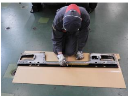
溶接点 42 箇所をマーキング
