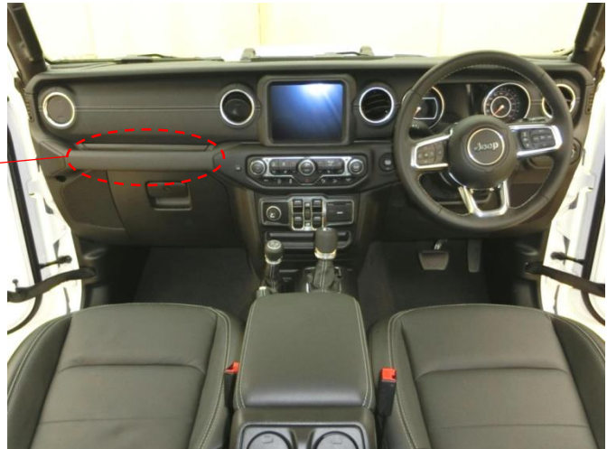
パッセンジャエアバッグはボルトで取付けられている。ハーネスを縁切って取外す。
