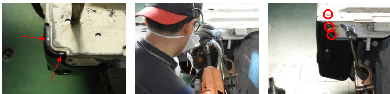
パネル B の出代を調整して固定
