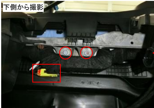
パッセンジャエアバッグはボルトで取付けられている。ハーネスを縁切って取外す。
