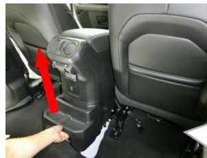
フロアコンソールベース後部を持上げて取外す。
