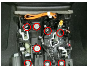
トランスファケースシフト、トラ ンスミッションシフト ボルトで取付けられている。 ハーネスを縁切る。
