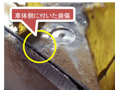
一部エアソーで切削した箇所の状態
