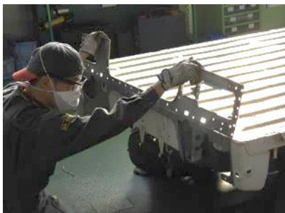
パネル A は上下に繰り返し繰り返し折り曲げて取外す
