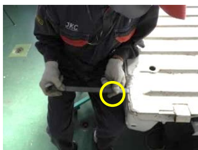
段付き加工端部から 6mm の位置にマーキング
