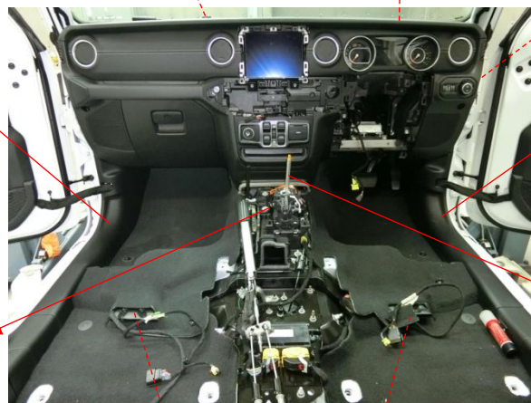
インストルメントパネルキャップ ツメで取付けられている。
