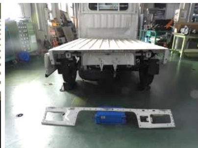
パネル A は上下に繰り返し繰り返し折り曲げて取外す
