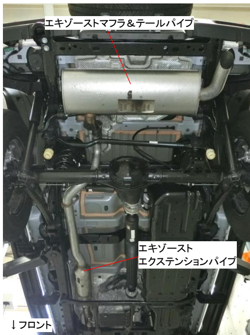
エキゾーストマフラ&テールパイプ、エキゾースト エクステンションパイプ取外し状態
