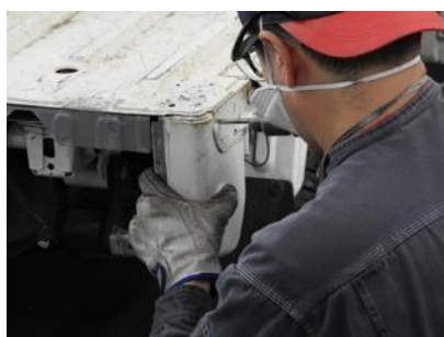
側面のスポット溶接 4 点を切削
