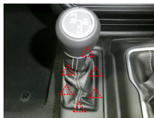
トランスファースhiftノブ ツメで取付けられている。
