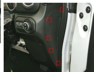
インストルメントパネルエンド (両側) クリップで取付けられている。 ロワスカップモールディング フロントシルカバーを取外す。
