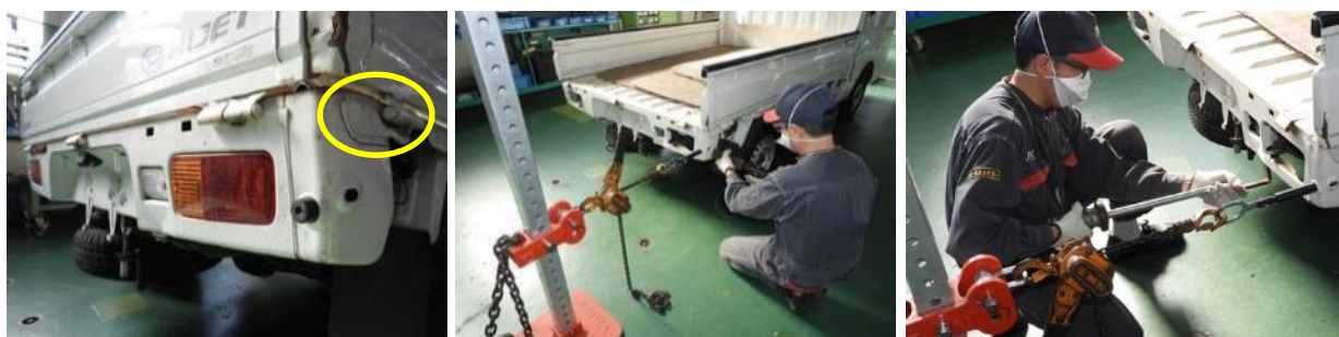
パネル C 右側面部の変形
