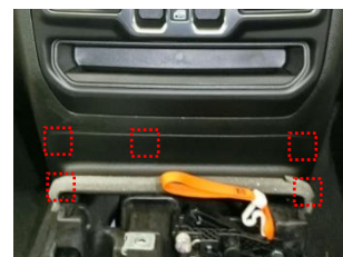
インストルメントパネルセンタ ベゼル クリップで取付けられている。
