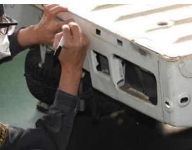
スポット溶接点をマーキング
