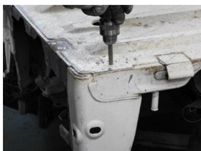
上面のスポット溶接 2 点を切削
