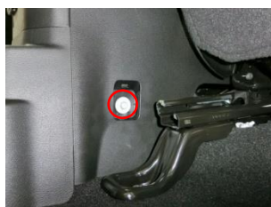
両側コンソールプラグを取外し、ボルトを外す。
