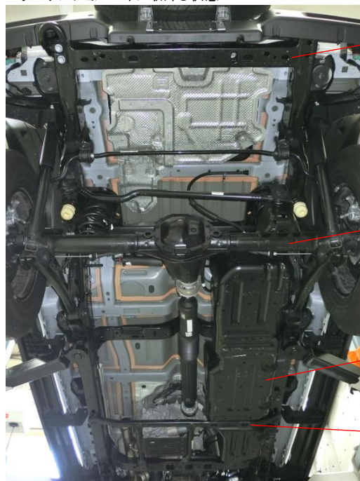
エキゾーストマフラ&テールパイプ、エキゾースト エクステンションパイプ取外し状態
