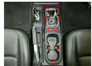
ギアシフトインディケータベゼル クリップで取付けられている。 ハーネスを縁切る。
