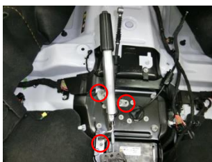
パーキングブレーキレバー Assy ナットで取付けられている。 ケーブルを縁切る。
