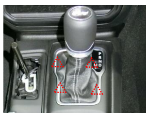
トランスミッションシフト ツメで取付けられている。
