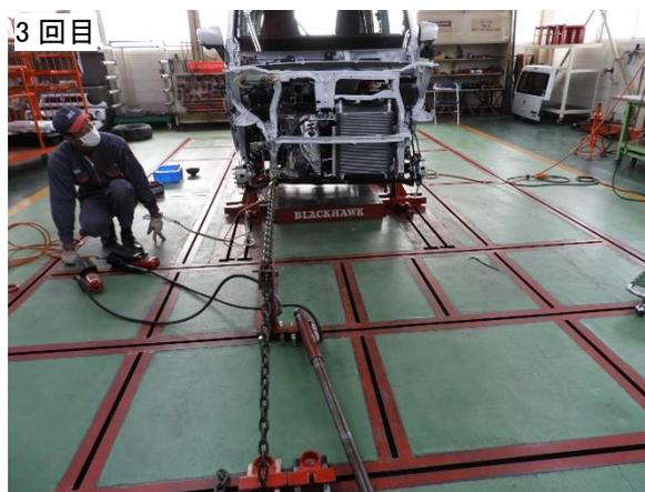
基本修正に際し、軽自動車の多くは車体寸法規格内で最大限の室内長（空間）を確保するため、登録車のような強固なバンパメンバ（バンパラインホース）を装着していない。よって、バンパラインホースを直接引き、変形したバンパラインホースの形状を復元することで左右のフロントサイドメンバやフェンダエプロンパネルを修正するといった、押込みと左右部材の振れを同時に修正するといった効果的な修正方法を行うことが難しく、左右個別の修正になる場合が多いと思われる。
