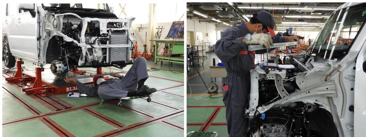
エンジンやサスペンションが取付状態での計測であるため、全ての計測点での測定ができない。測定可能な計測点および無損傷部位との比較計測などを加え、計測精度を高めている。
