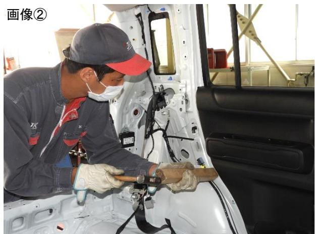
リヤホイールハウスおよびクォータパネルの引出し作業
