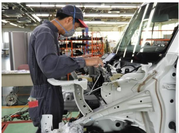
4回目の引き作業の結果確認、右フロントサイドメンバは、左方向の振れは復元傾向であるが持ち上がりが解消せず、クランプ位置を変え再度の修正を行う。
