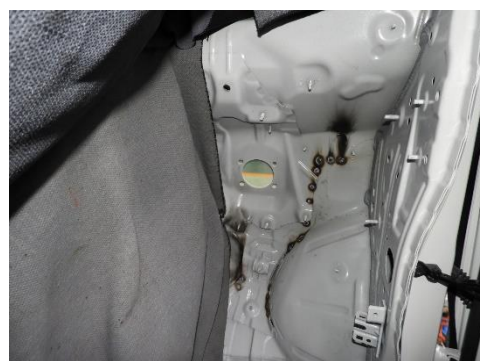
フロントサイドメンバ、フェンダエプロンパネルの溶接痕の状態および位置
