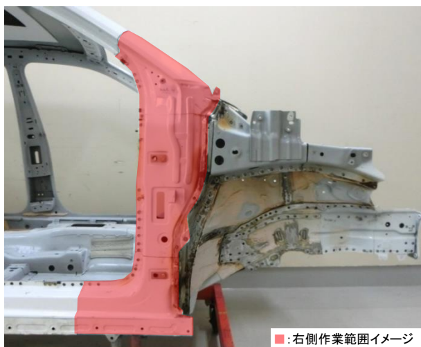
Aピラーアウト、ホイールハウジングサイドメンバアウト取外し状態
